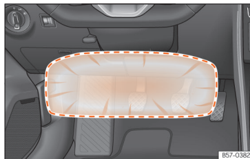
SL. 35 Na vozačevoj strani: područje djelovanja zračnog jastuka za koljena.
