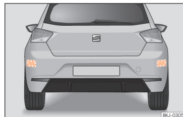
Sl. 99 Područje iza vozila: područja radarskih senzora.
