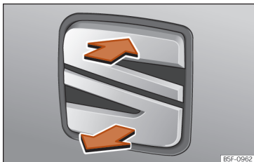
Sl. 57 Stražnji poklopac: Otvaranje izvana
