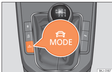
Sl. 93 Pored ručice mjenjača: tipka MODE.
