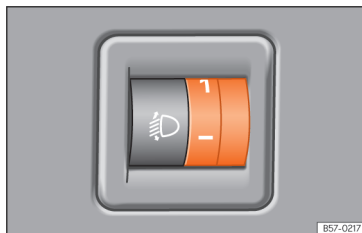
SL 74 Pored kola upravljača: regulator za regulaciju visine svjetlosnog snopa.
