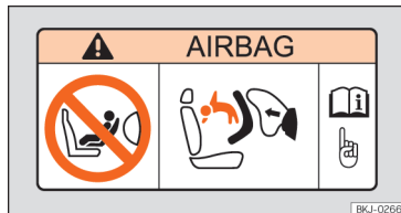
Sl. 35 Etiketa zračnog jastuka: na zaslonu za sunce na suvozačevoj strani.
