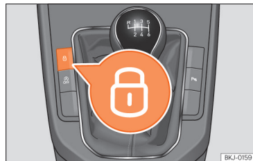
SL 52 Središnja konzola: tipka centralnog zaključavanja.
