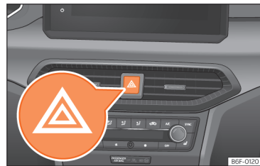
Sl. 43 Instrumentna ploča: prekidač uređaja za svjetlosno upozorenje
