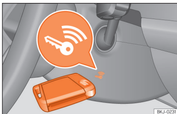
Sl. 86 Desno na stupu upravljača: pokretanje u nuždi.
