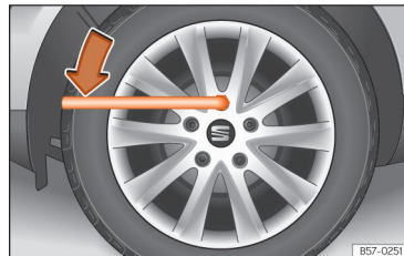
SL. 187 Zamjena kotača: otpuštanje vijaka kotača
