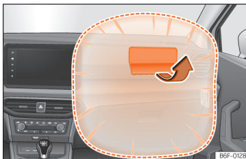
Sl. 28 Suvozačev zračni jastuk u instrumentnoj ploči
